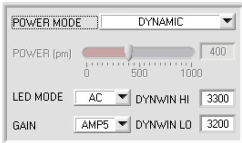
**DYNAMIC:** Die Sendeleistung wird automatisch anhand der am Empfänger ankommenden Strahlungsmenge dynamisch geregelt. Der Regelkreis versucht anhand der an den Empfängern gemessenen Intensitäten die Sendeleistung automatisch so einzustellen, dass der Dynamikbereich, welcher mit **DYN WIN LO** und **DYN WIN HI** festgelegt wird, möglichst nicht verlassen wird.
