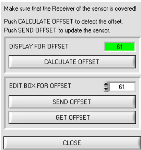
Um zur Offsetkalibrierung zu gelangen, muss in der Registerkarte **PARA** ein Doppelklick mit der rechten Maustaste links neben **INTEGRAL** durchgeführt werden
