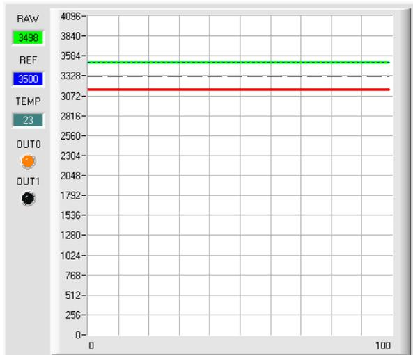
Solange der aktuelle Messwert **RAW** (grüne Linie) oberhalb der Schaltschwelle (rote Linie) liegt, ist der Ausgang **OUT0** auf +24V (Signal ist in Ordnung). Dies wird über die LED **OUT0** visualisiert
