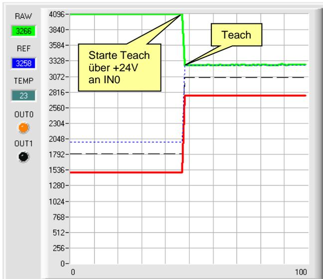
Nach einem positivem Signal (+24V) am Eingang IN0 wird die Sendeleistung so eingestellt, dass sich der Sensor im Dynamikbereich, welcher mit **DYN WIN LO** und **DYN WIN HI** eingestellt wird, befindet.
